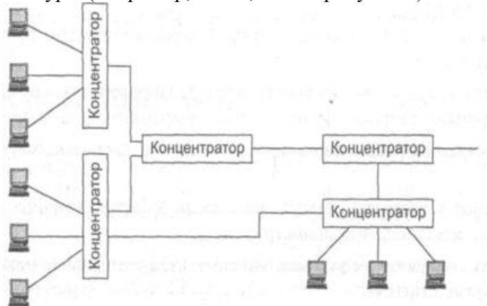
Рис.2. Замкнутый контур в сети Ethernet на концентраторах.
